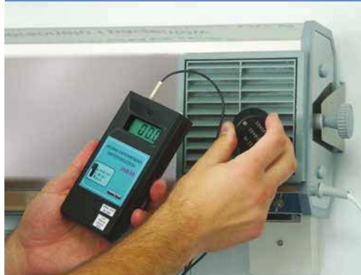
Bezpečnost pro osoby – měření ozařování pomocí měřidla ukazuje hodnotu 0.
